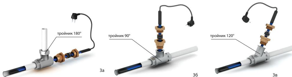
Рис.3. Схемы ввода нагревательной секции внутрь трубопровода:
