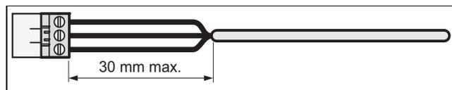
3. Удаляйте внешнюю оплетку гибких проводов макс. на 30 мм, чтобы предотвратить короткое замыкание при освобождении одной жилы.
