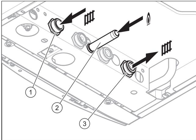
1. Выполните монтаж газопровода с помощью прилагаемого запорного крана к газовому штуцеру (2) без механических напряжений.
