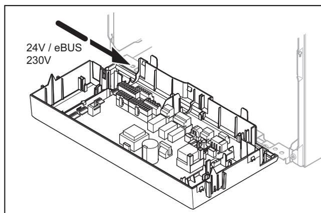
1. Проведите соединительные провода подсоединяемых компонентов через кабельный ввод слева через нижнюю сторону изделия.
