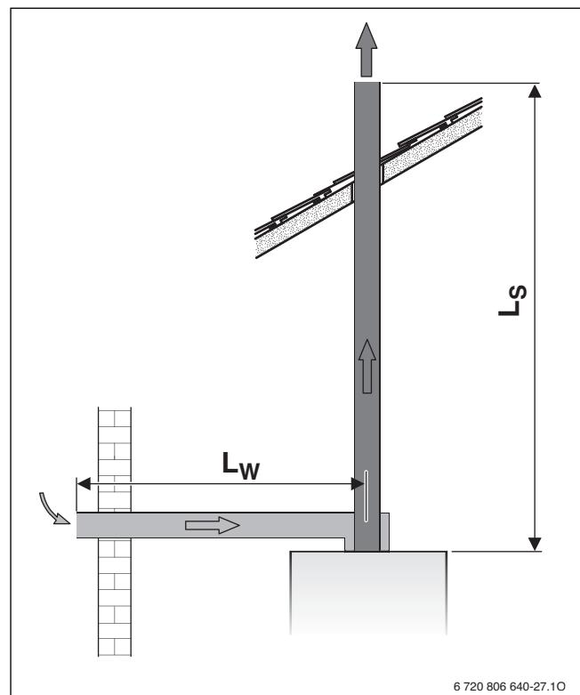
Рис. 12 Отвод дымовых газов по С<sub>52</sub> с отдельной трубой
