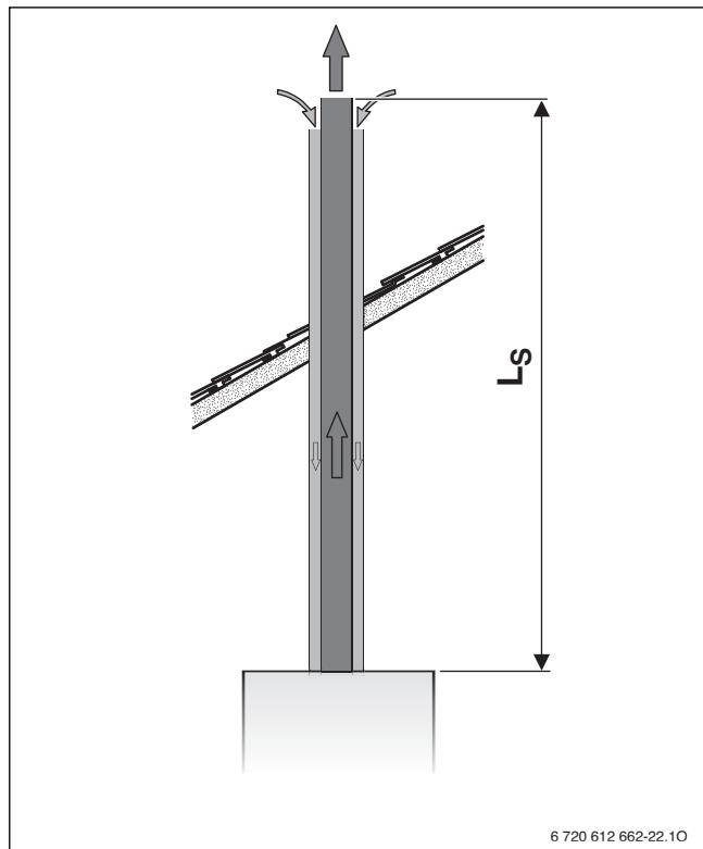
Рис. 9 Вертикальный отвод дымовых газов по C<sub>32</sub> с концентрической трубой
