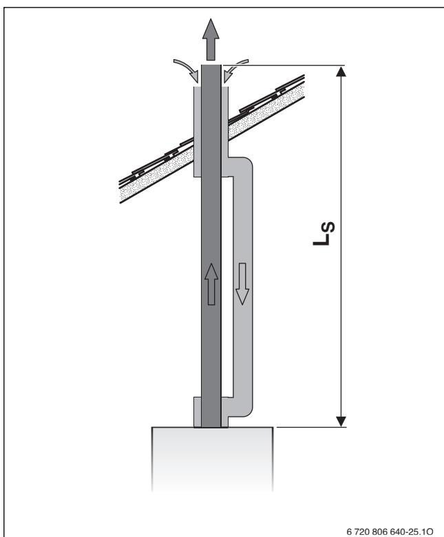
Рис. 11 Вертикальный отвод дымовых газов по С<sub>32</sub> с отдельной трубой
