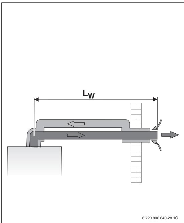
Рис. 10 Горизонтальный отвод дымовых газов по С<sub>12</sub> с отдельной трубой
