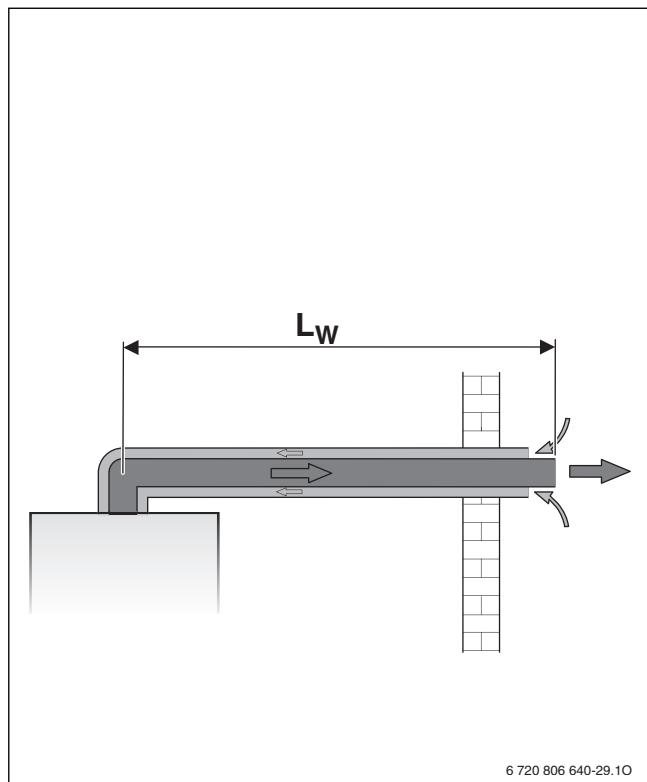
Рис. 8 Горизонтальный отвод дымовых газов по C<sub>12</sub> с концентрической трубой
