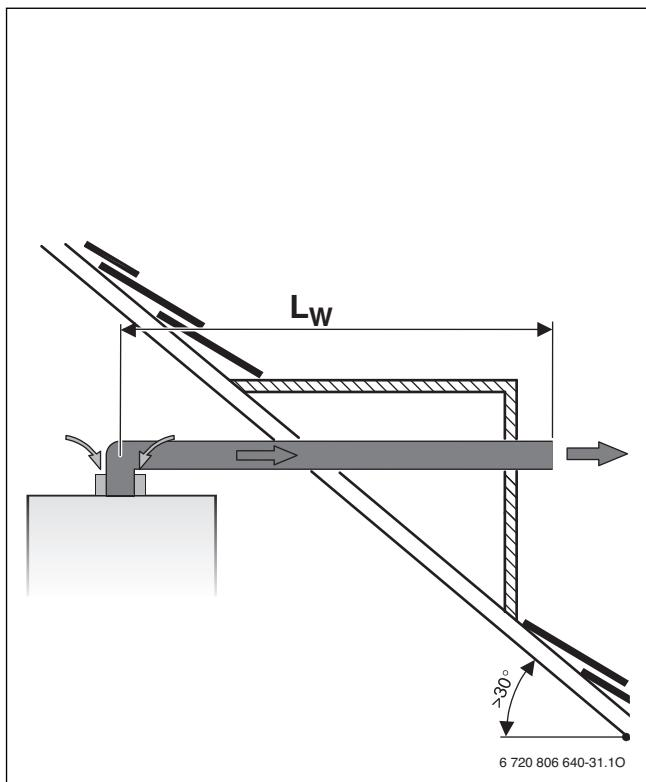
Рис. 6 Горизонтальный отвод дымовых газов по B<sub>22</sub>
