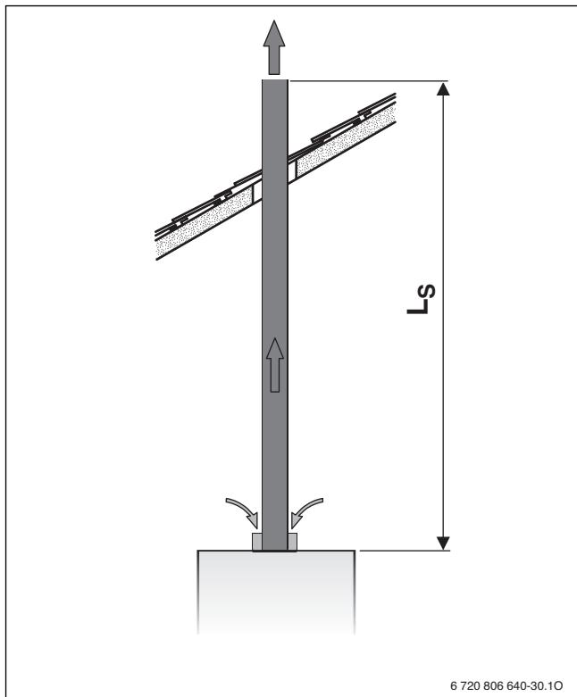
Рис. 7 Вертикальный отвод дымовых газов по B<sub>22</sub>
