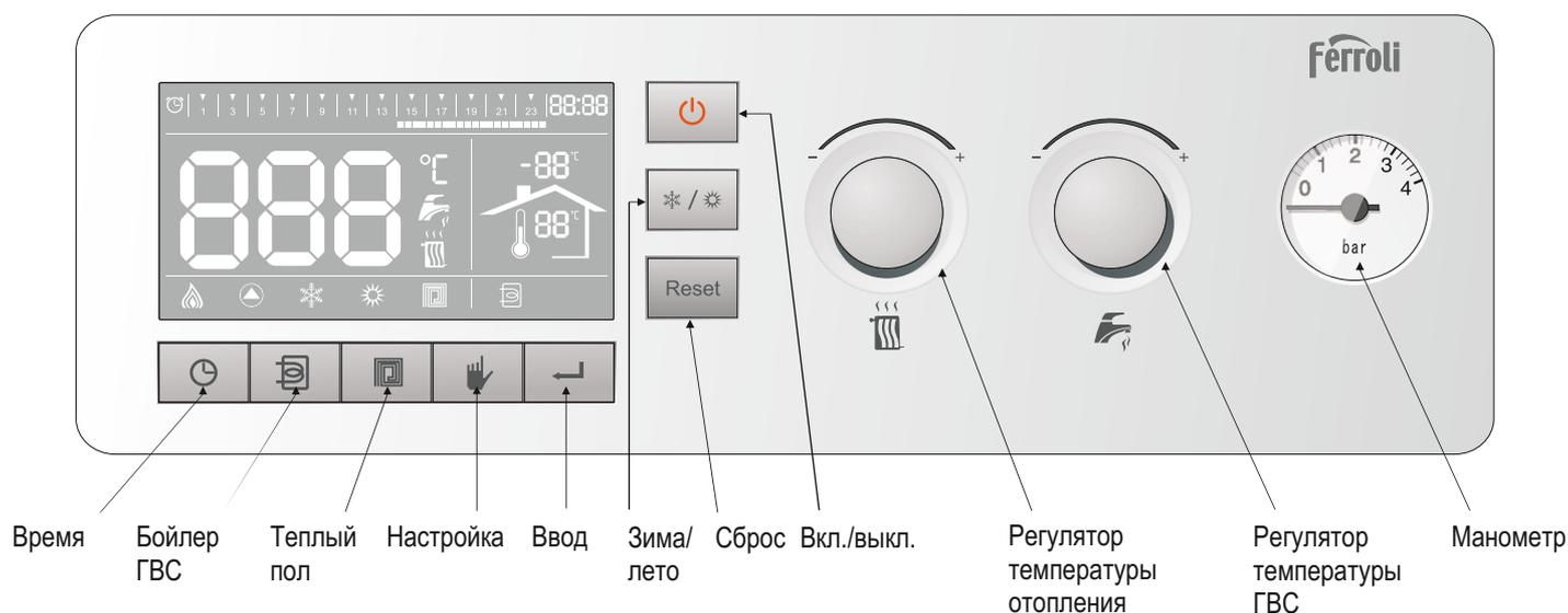
1. **Кнопка «Время».** Одним коротким нажатием активируется функция суточного программирования отопления. Удержания кнопки нажатой в течение 3 секунд приведет к настройке времени и интервалов. В «летнем» режиме кнопка не функционирует.
