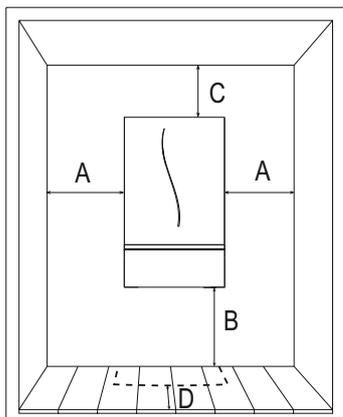
Рис. 4. Размещение котла
