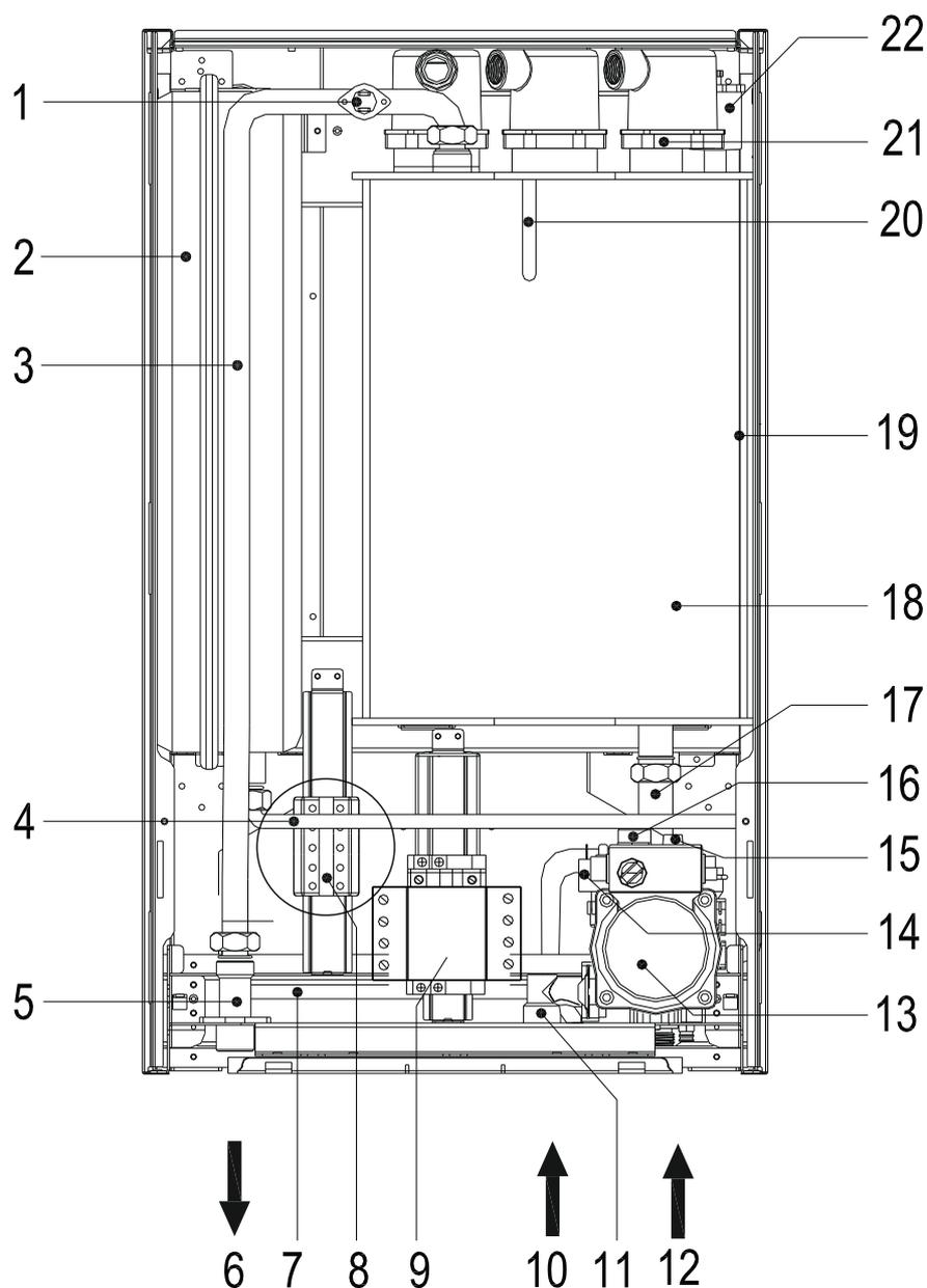
Рис. 96. Общий вид котлов 12; 15; 18; 21; 28 кВт
