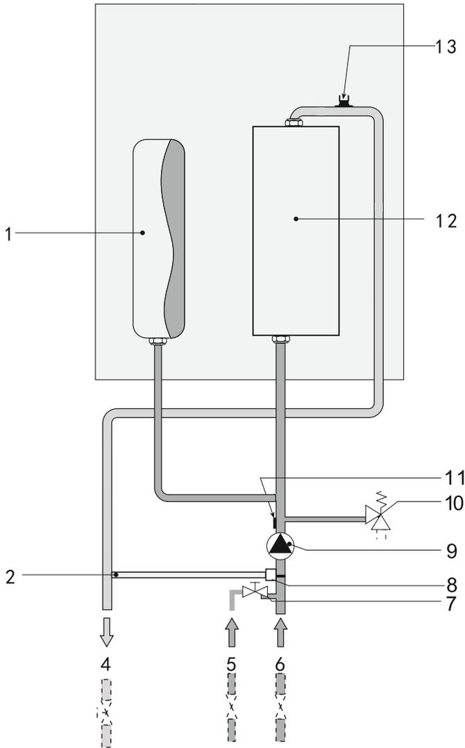
Рис. 10. Гидравлическая схема
