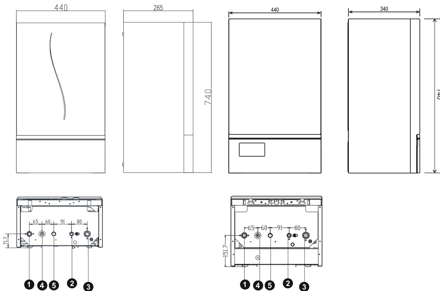
Рис. 8. Габаритные и присоединительные размеры
