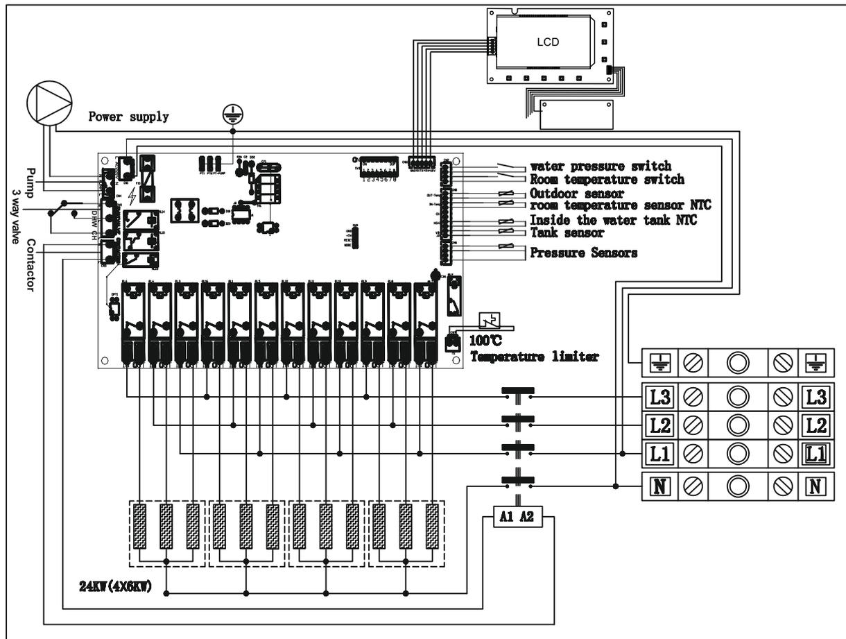
Рис. 13. Принципиальная электрическая схема LEB 12 - LEB 28
