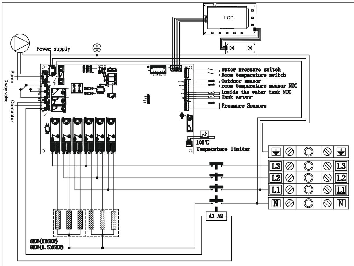
Рис. 12. Принципиальная электрическая схема LEB 6 - LEB 9
