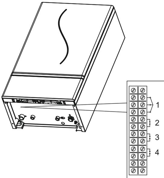
**Рис. 7. Подключение 3 ходового клапана, датчика бойлера, комнатного термостата и датчика уличной температуры**
