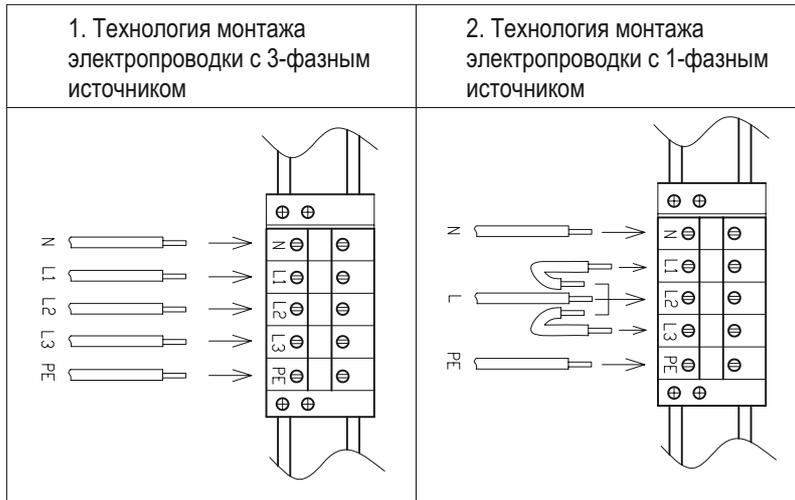
Рис. 6.Электрические подключения
