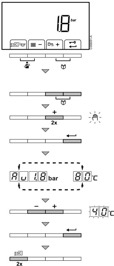
В некоторых случаях требуется перевести котел в ручной режим работы, например, когда система регулирования еще не подключена. Под символом - котел может быть переведен в автоматический или ручной режим работы. Для этого выполнить следующие операции :
