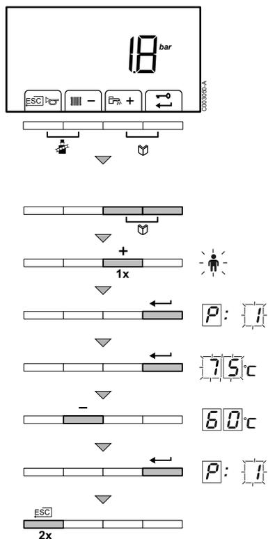
1. Нажать одновременно на две клавиши , затем - на клавишу **[+]**, пока не отобразится мигающий символ в графическом индикаторе меню.
