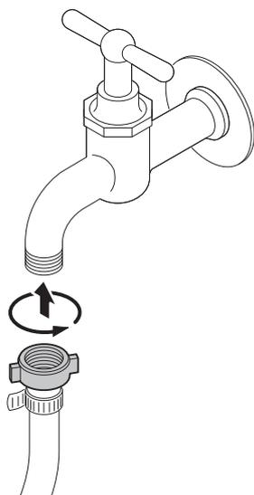
6. Подсоединить шланг для заполнения к водопроводному крану (холодной воды).
