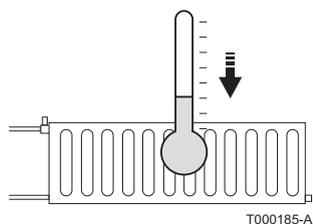
4. Перед заполнением установки центрального отопления подождать, пока температура упадет ниже 40 °C и радиаторы будут холодными.
