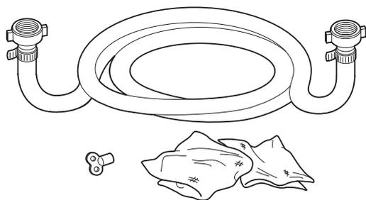
5. Для добавления воды использовать шланг для заполнения с двумя фитингами, тряпку и ключ для воздухоотводчиков.
