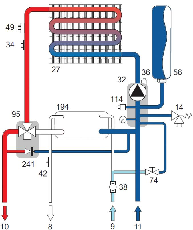
рис. 17 – Отопительный контур
