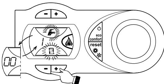
рис. 13 – Режим TEST (мощность системы отопления = 100%)
