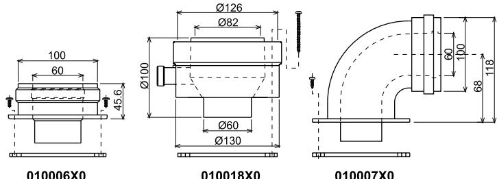
рис. 9 – Начальные элементы для коаксиальных воздуховодов
