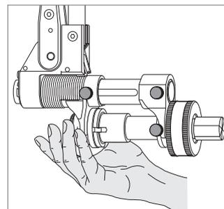
Ваш инструмент оснащен расширительной системой RO REHAU. Чтобы избежать повреждения трубы не комбинируйте части расширительной системы REHAU RE (которые выпускались до 1996) с компонентами расширительной системы REHAU RO.
