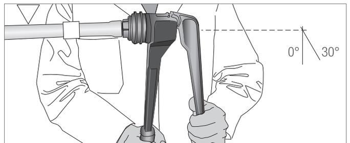
4. Вставьте штуцер фитинга в трубу до последнего ребра (до упора). Через некоторое время фитинг будет прочно держаться в трубе (память формы).
