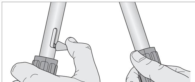
9. **Еще раз** свести рукоятки инструмента вместе. Затем резко поднять подвижную рукоятку инструмента на 90° для того, чтобы привести инструмент в исходное положение.
