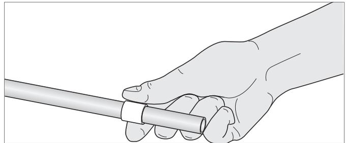
3. Расширение с помощью экспандера: Расширьте трубу один раз и повторите операцию повернув трубу на 30°. При этом обратите внимание на минимальное расстояние (одна длина подвижной гильзы) между расширительной насадкой и подвижной гильзой.
