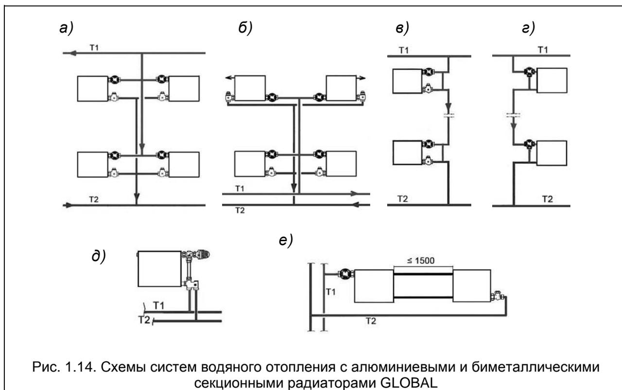
Рис. 1.14. Схемы систем водяного отопления с алюминиевыми и биметаллическими секционными радиаторами GLOBAL
