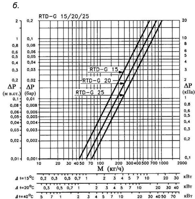
Рис. 2.2. Гидравлические характеристики терморегуляторов фирмы «Данфосс»:
