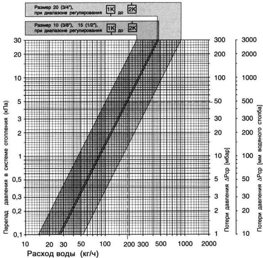
Рис. 2.4. Характеристики терморегуляторов уменьшенного гидравлического сопротивления фирмы «Heimeier»
