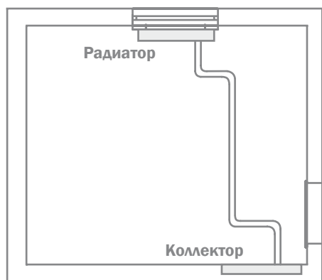
Пример прокладки трубы с учетом термического удлинения
