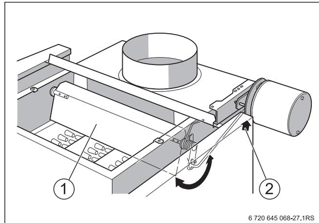
Рис. 35 Заслонка дымовых газов в положении "Закрыто"
