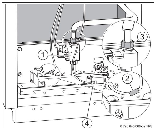
Рис. 42 Демонтаж горелки
