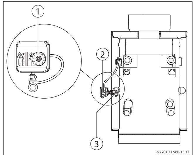
Рис. 48 Установка реле контроля давления газа
