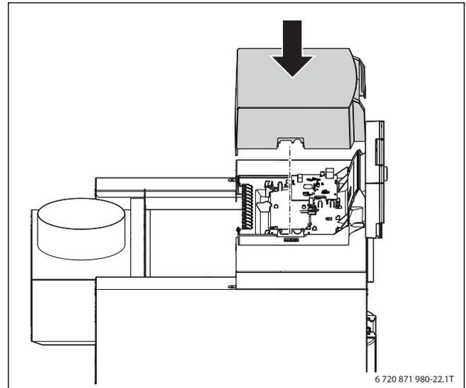
Рис. 21 Установка верхней крышки системы управления
