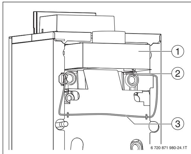
Рис. 34 Устройства контроля дымовых газов
