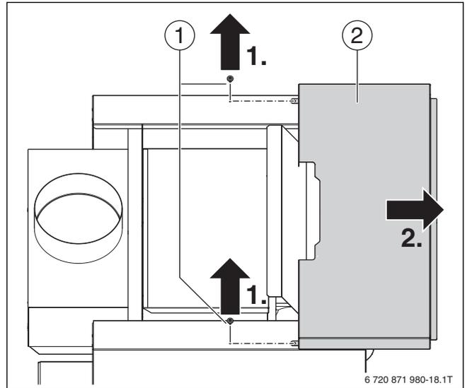
Рис. 14 Установка передней крышки котла в сервисное положение
