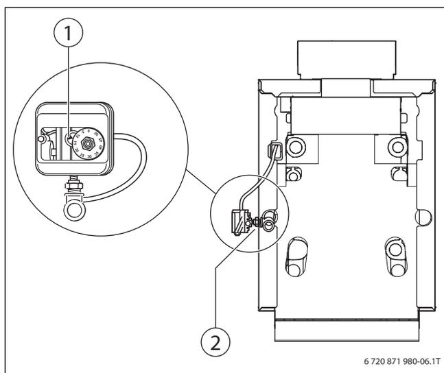
Рис. 8 Подключение газа
