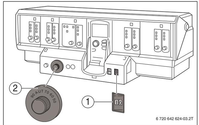
Рис. 8 Включите отопительную установку на системе управления (Logamatic 4000)
