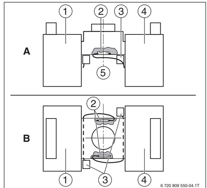
Рис. 4 Датчики температуры дымовых газов в сдвоенном котле
