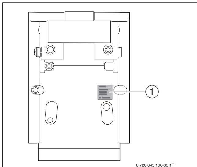
Рис. 5 Расположение заводской таблички на отдельном котле
