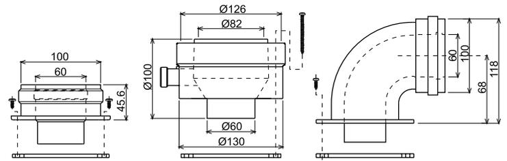
рис. 9 – Начальные элементы для коаксиальных воздуховодов
