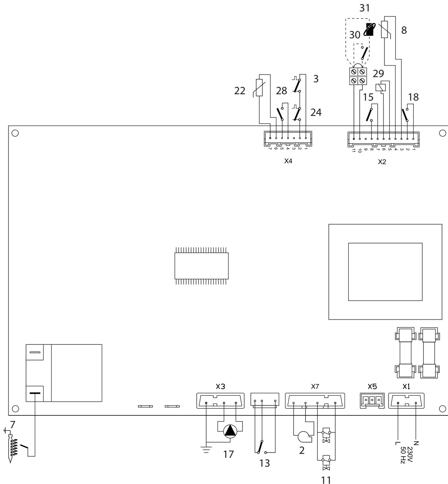
рис. 19 – Электрическая схема
