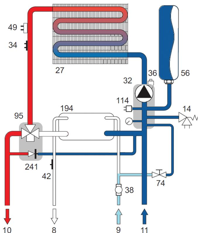
рис. 17 – Отопительный контур
