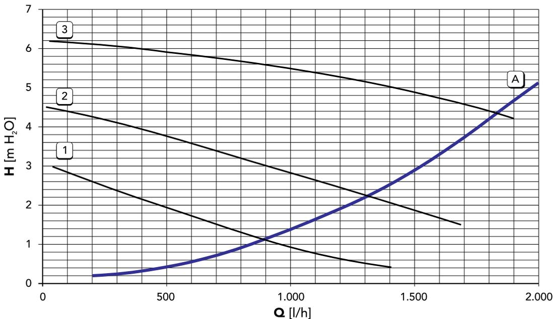
A = Потери напора в котле – 1, 2 и 3 = Скорость циркуляционного насоса
