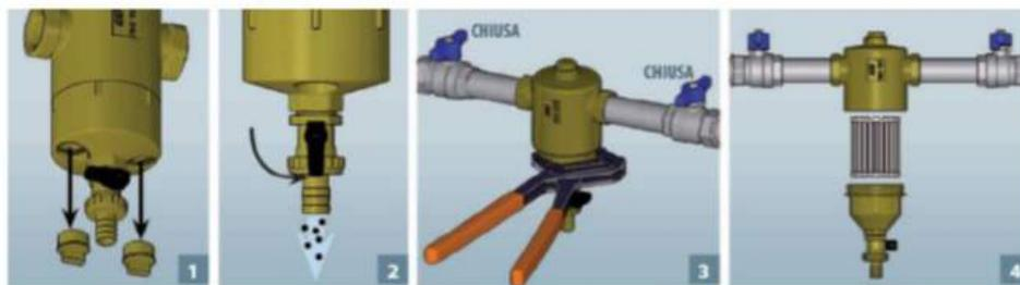
Требуется периодически очищать внутренний фильтр. Для этого закрываются шаровые краны, отвинчивается нижняя часть корпуса с помощью газового ключа и вынимается картридж. После очистки картриджа вставьте его на место и закрутите нижнюю часть корпуса.
