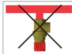
Сбросные трубы не должны мешать нормальной работе клапана, а сбрасываемая вода не должна наносить ущерб людям и имуществу.
