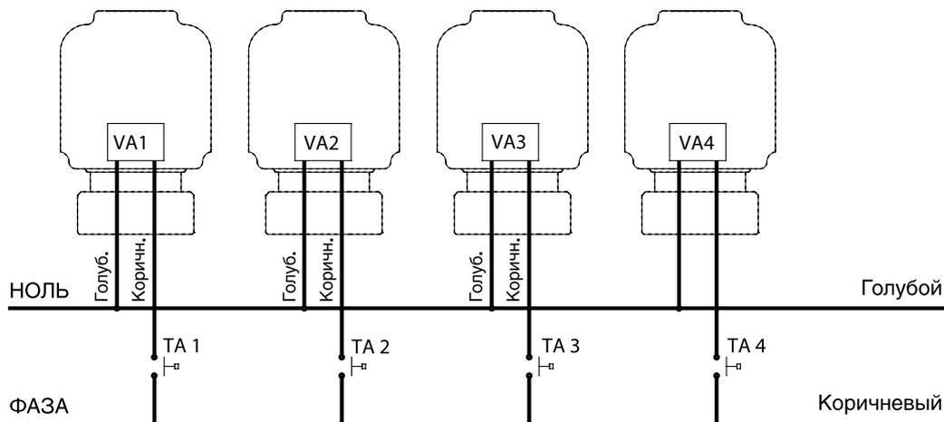
**Электротермический привод обеспечен двумя проводами:**
