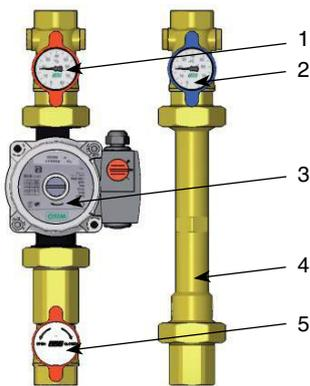
1. Шаровой кран на подающей линии с красной ручкой и встроенным термометром со шкалой до +80 °С
