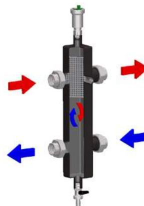
Внутри ёмкости ГР расположена перфорированная пластина-фильтр, на которой отделяются из потока шлам и пузырьки воздуха. Малая скорость жидкости в емкости позволяет пузырькам свободно всплывать вверх по пластине под купол емкости, где они далее удаляются автоматическим воздухоотводчиком, а шлам оседает на дно, и может быть выведен через сливной кран.
