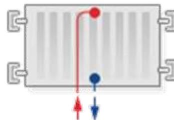
У трубчатых радиаторов DeLonghi Multicolonna подающий и обратный теплопроводы подсоединяются к нижнему коллектору, но перегородкой разделяется циркуляция по потокам.
