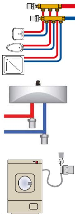
Компенсатор гидроударов рекомендуется устанавливать на конце трубопровода к потребителям (шаровые краны, сантехнические приборы, моторизованные клапаны и т. п.) или на коллекторах.
