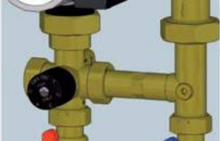
Окончательная калибровка осуществляется по показанию термометра в шаровом кране, установленном на подающей линии в низкотемпературный контур. Пропускная способность смесительного клапана Kv = 2,9 м³/ч.
