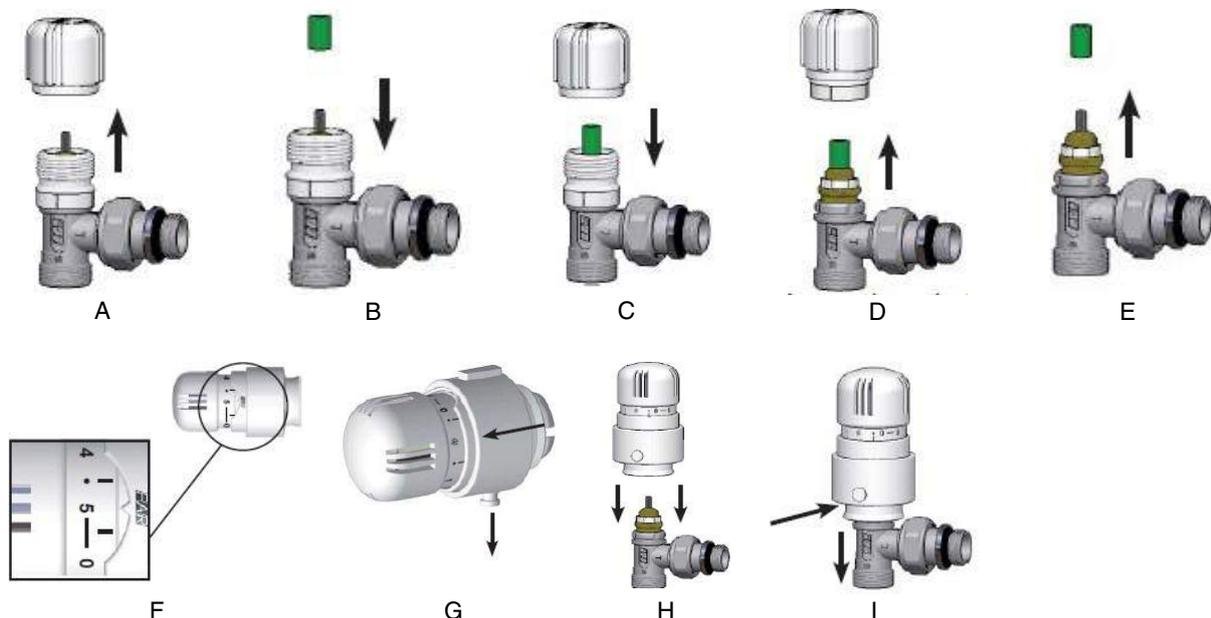
Для установки электротермической головки снимите пластиковую ручку, пластиковую муфту и наверните адаптер код 1941.
