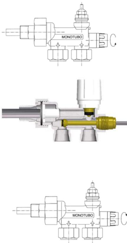
1. Отвинтите защитную крышку отсекаателя.
