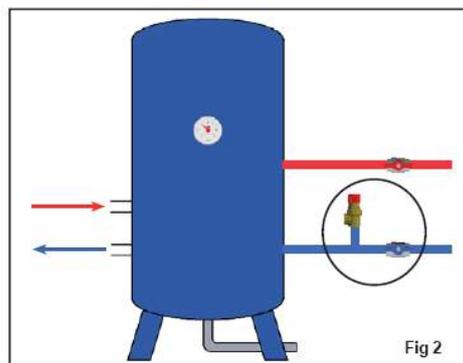
Клапаны должны устанавливаться в верхней части теплогенератора, длина трубопровода до клапана не должна превышать 1 м. При установке на бойлер ГВС между клапаном и баком не должно быть никакой запорной арматуры.
