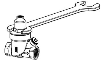
3) Используя ключ 25 мм снять колпак
