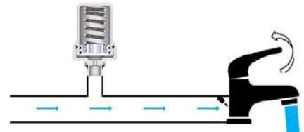
При закрытии потребителя давление в трубопроводе увеличивается и компенсатор гидроударов FAR поглощает избыточное давление, обеспечивая защиту компонентов системы.
