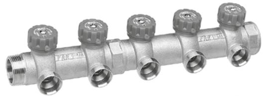
Коллекторы MULTIFAR можно использовать как в системе горячего и холодного водоснабжения, так и в отопительных системах радиаторного и напольного отопления. Благодаря вентилям, установленным на каждом ответвлении, можно устанавливать или заменять оборудование без отключения или опорожнения всей системы.
