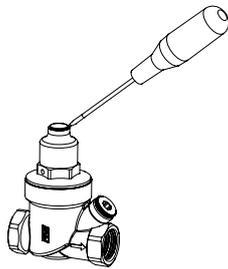
1) Используя отвертку снять защитную крышку и винт
