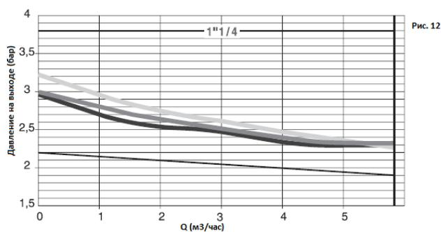
В целом результаты подтверждают, что редуктор не создает чрезмерного сопротивления и регулирует расход в соответствии с требованиями минимального изменения давления на выходе редуктора.
