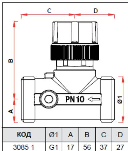
В отверстия для температурного зонда коническая резьба W 10x19
