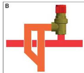
Схема установки предохранительного клапана SOLAR-FAR (код 2006) в систему солнечного обогрева.
