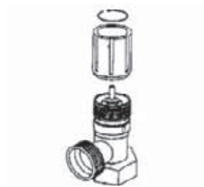
2) Полностью отвинтите регулирующую ручку
