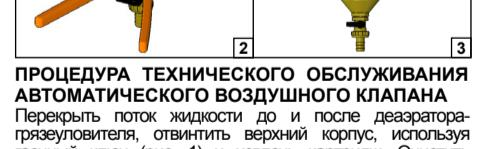
**ПРОЦЕДУРА ТЕХНИЧЕСКОГО ОБСЛУЖИВАНИЯ АВТОМАТИЧЕСКОГО ВОЗДУХООТВОДЧИКА**
