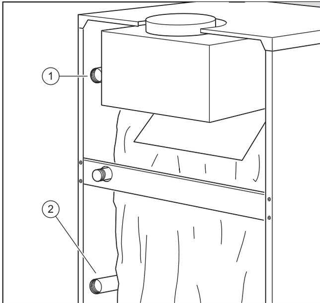
3. Подсоедините подающую линию системы отопления к подключению подающей линии системы отопления (1).
