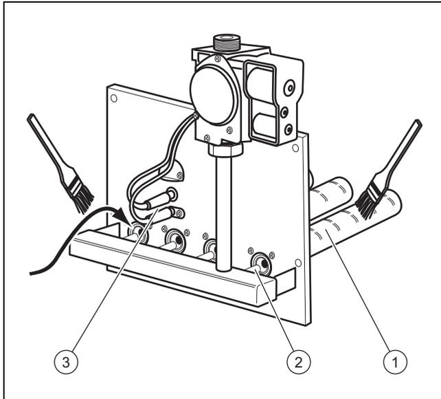
1. Очистите трубки горелки (1) кисточкой или щёткой. Особо тщательно очищайте область первичного воздухозабора и выходные отверстия.
