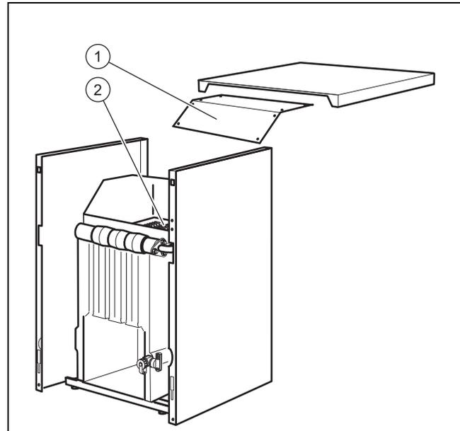
3. Выверните винты крепления щитка (1) и снимите его.
