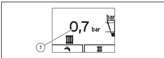
1. Считайте давление наполнения системы отопления на дисплее (1)..
