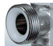
Клапаны разделяются на подсоединение металлопластиковых, пластиковых или медных труб через компрессионные фитинги FAR с гайками с метрической резьбой 24x19 (обозначение «24x19») и со специальной расточкой под них и на подсоединение с трубной резьбой (обозначение «G»).
