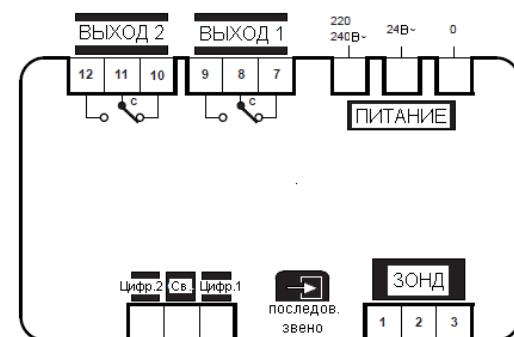
Зонд температуры потока должен подключаться к клеммам с маркировкой **зонд № 2 и 3**.
