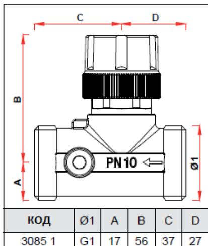
В отверстии для температурного зонда коническая резьба W 10x19
