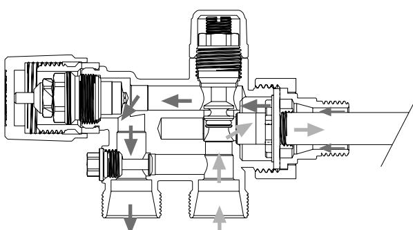
Подсоединения узла код 1438 выполнены под концовки FAR с метрической резьбой 24x19 для подключения медных, пластиковых или металлопластиковых труб. Расстояние между центрами отводов 35 мм. Подключение подающей указано на корпусе стрелкой и располагается со стороны радиатора.
