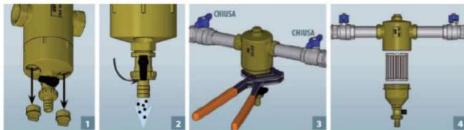
Требуется периодически очищать внутренний фильтр. Для этого закрываются шаровые краны, отвинчивается нижняя часть корпуса с помощью газового ключа и вынимается картридж. После очистки картриджа вставьте его на место и завинтите нижнюю часть корпуса.
