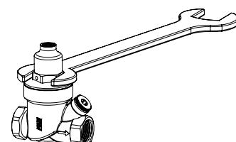
3) Используя ключ 25 мм снять колпак
