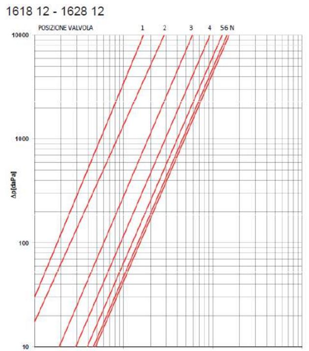
**Зависимость настройки клапана Dy 15 мм с термоголовкой в режиме 2 К от расхода и перепада давления на нем**
