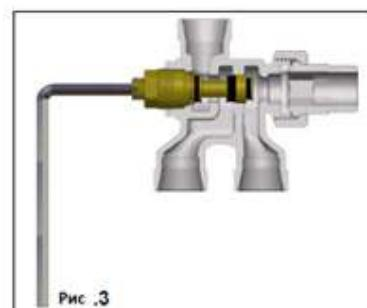
Регулирование запорного вентиля осуществляется при помощи шестигранного ключа «5 мм» или плоской отвертки (рис. 3).
