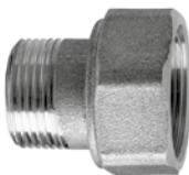
Трубы и арматура с трубной резьбой подсоединяются на отводы с помощью переходников (4) код 8791, имеющих с одной стороны внутреннюю резьбу M33x1.5, а с другой стороны наружную трубную резьбу 3/4".
