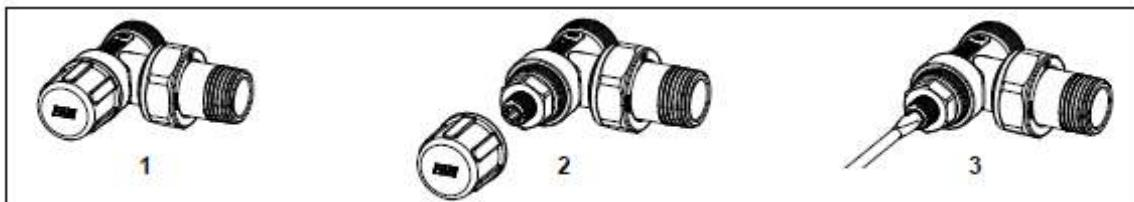
**Регулирующий вентиль** снабжён пластиковой ручкой, удобной для лёгкого управления и установки требуемого теплового режима отопительного прибора. Ручная регулировка производится, начиная с полностью закрытого положения, переводом в открытую положение.
