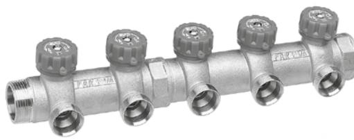
Коллекторы MULTIFAR можно использовать как в системе горячего и холодного водоснабжения, так и в отопительных системах радиаторного и напольного отопления. Благодаря вентилям, установленным на каждом ответвлении, можно устанавливать или заменять оборудование без отключения или опорожнения всей системы.
