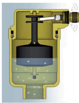
При наличии воздуха уровень теплоносителя опускается и поплавок открывает затвор.
