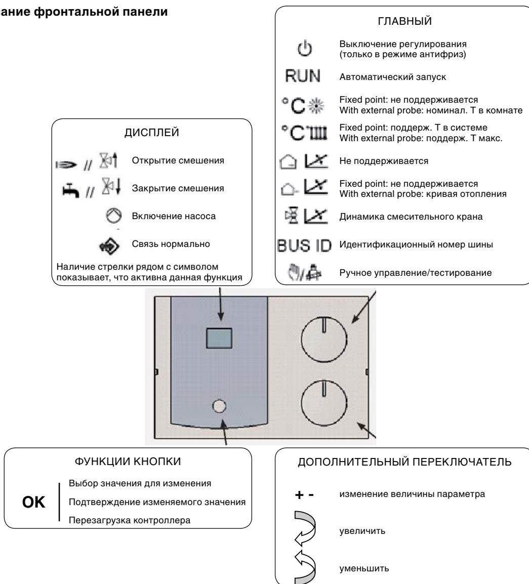
Предустановленная программа в контроллере позволяет:
