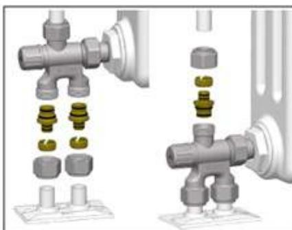
Пример установки с использованием концовок (код 6055) для металлопласт. труб.
