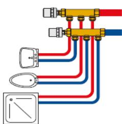
Компенсатор гидроударов рекомендуется устанавливать на конце трубопровода к потребителям (шаровые краны, сантехнические приборы, моторизованные клапаны и т. п.) или на коллекторах.
