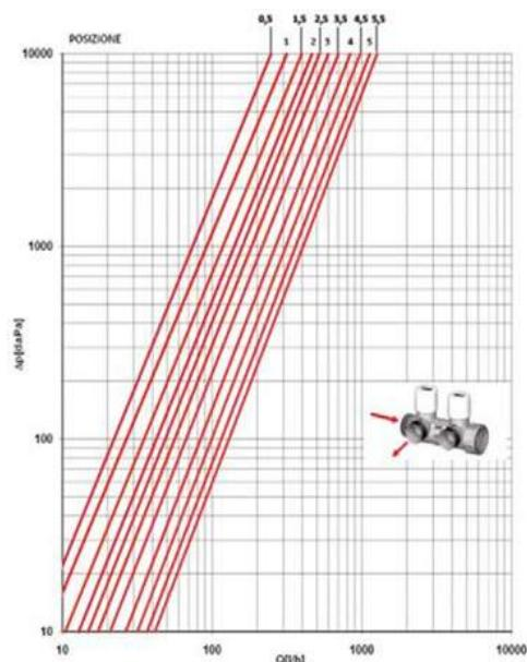
Вентиль позволяет произвести плавную и точную балансировку каждого контура в диапазоне пропускной способности от 0,3 до 1,2 м<sup>3</sup>/ч.
