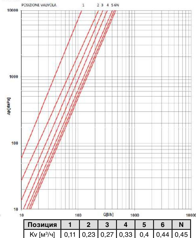
**Пример выбора позиции настройки клапана с термоголовкой, установленного в двухтрубной системе водяного отопления**
