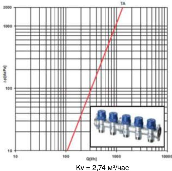
Гидравлические потери в терморегулирующем коллекторе код 3914 1
