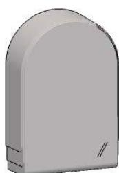
Датчик температуры наружного воздуха должен устанавливаться на Северной или Северо-Восточной стороне здания, на стене, куда не попадают прямые солнечные лучи, внезапные воздушные потоки или другое тепловое излучение, в защищенном от постороннего вмешательства месте. Высота установки датчика не менее 3 м от уровня земли. Монтаж датчика на стене осуществляется с помощью дюбелей (в комплект поставки не входят).
