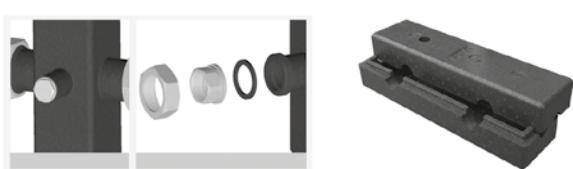
Штуцеры подсоединения контуров удобны для монтажа, так как являются разборными, состоят из фитинга, плоского кольцевого уплотнения и накидной гайки (код 2160). ГР может быть облачен в изолирующую противоконденсатную оболочку из вспененного полиэтилена, сформированную по форме ГР (арт. 2165).
