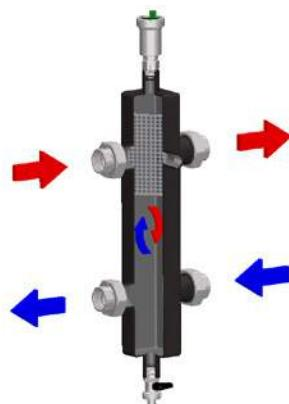
ГР должен быть установлен в вертикальном положении, чтобы обеспечить правильную работу автоматического воздухоотводчика. В ГР установлен обратный клапан для возможности снятия воздухоотводчика и облегчения планового обслуживания.
