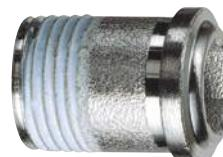
Тип 1 - со штуцером с резьбовым герметиком на водной основе Loctite Dri-Seal 5061 и уплотнительным гнездом под накидной гайкой из HPF.
