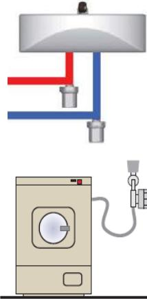
Если в системе имеется редуктор давления, то компенсатор гидроударов устанавливается до него.
