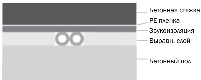
Пример прокладки трубопровода TECEflex в полу
