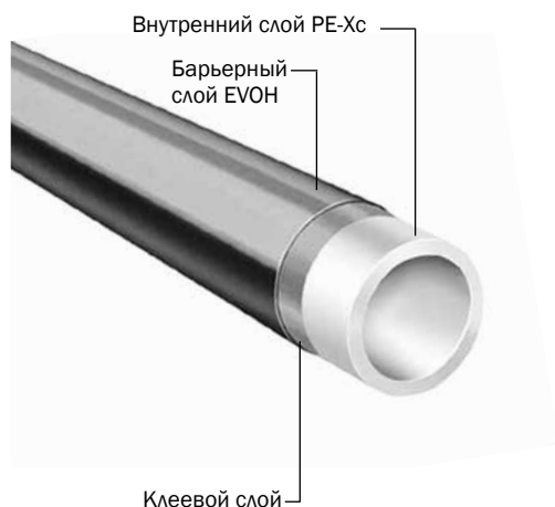
Труба TECEflex PE-Xc/EVOH для отопительных систем
