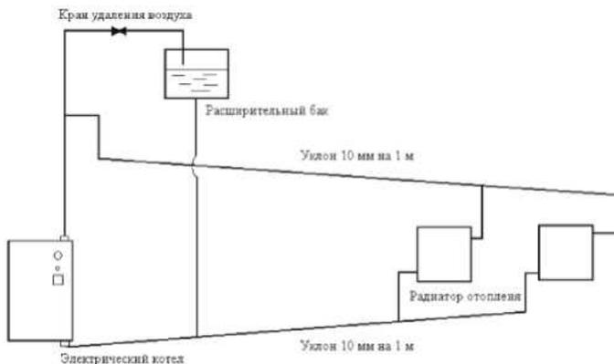
**Рис. 4 - Установка электрического котла с открытой системой отопления**
