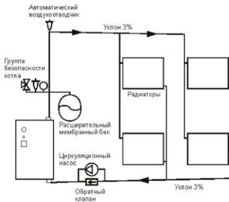
**Рис. 5 - Установка электрического котла с закрытой системой отопления**
