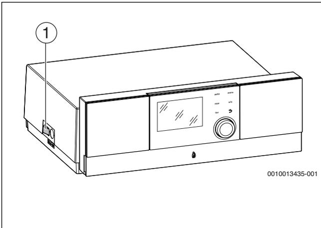
Рис. 37 Выключение отопительной установки (Logomatic MC110)
