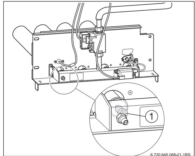
Рис. 27 Проверка форсунок основного газа
