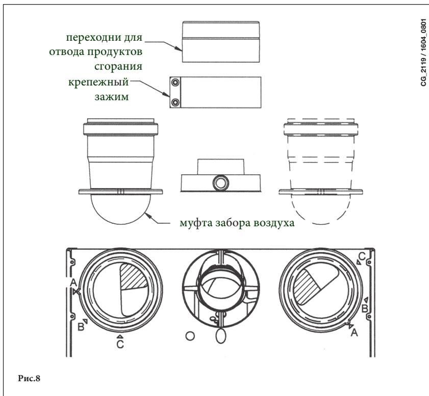
16.4 ГАБАРИТНЫЕ РАЗМЕРЫ СИСТЕМЫ ПРИТОКА ВОЗДУХА И ОТВОДА ПРОДУКТОВ СГОРАНИЯ ПО ДВУМ ОТДЕЛЬНЫМ ТРУБАМ
