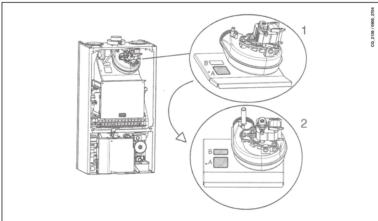
В некоторых случаях при установке системы удаления продуктов сгорания по отдельным трубам котёл может начать вибрировать. При этом возможна блокировка воздушного прессостата (код ошибки E03 на дисплее котла).
