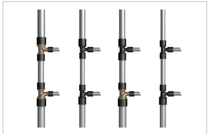
Рис. 5-6. Варианты подключения кольцевого трубопровода
