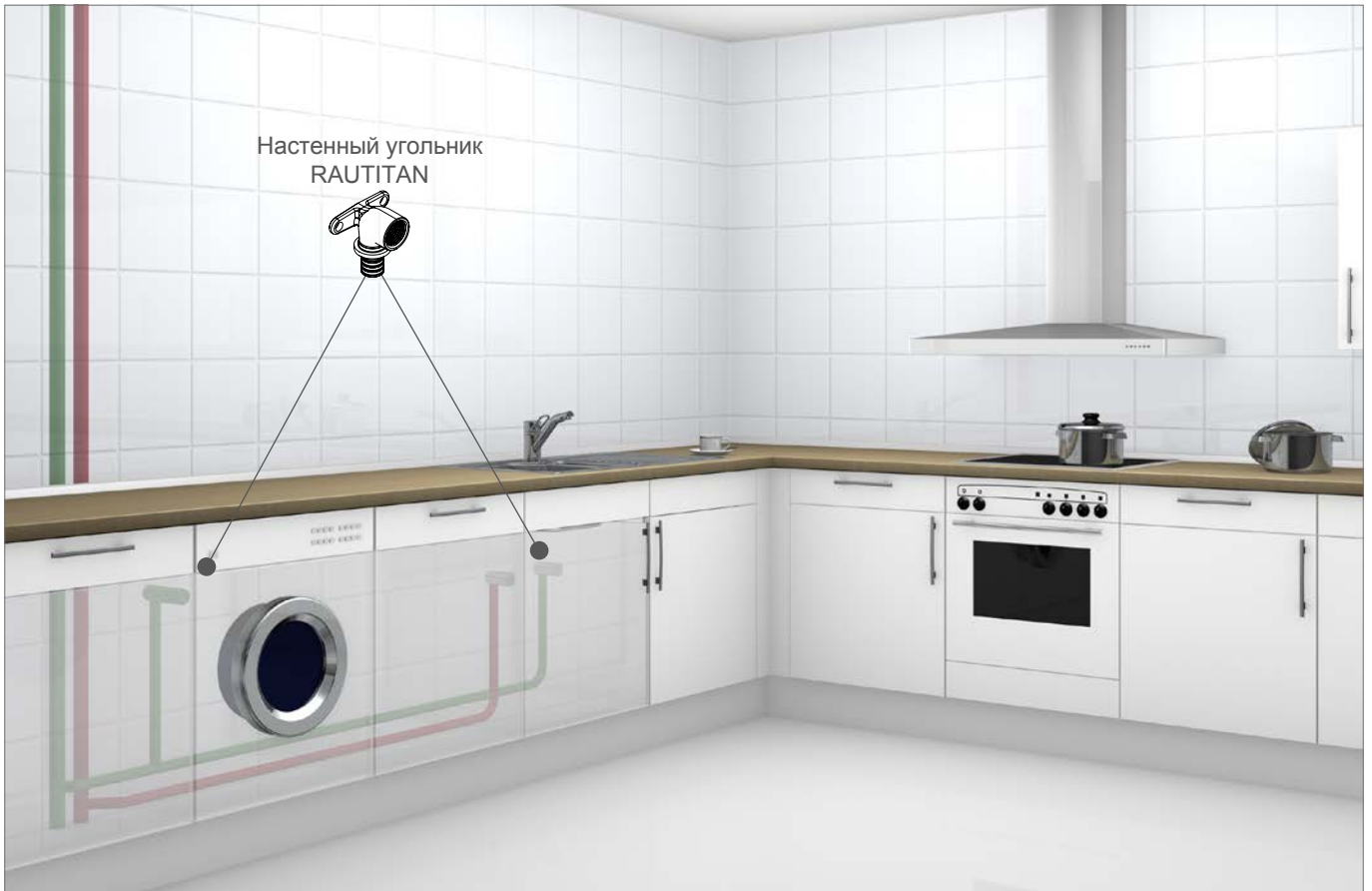
Рис. 5-2. Прокладка Т-образной трубки при поэтажной / индивидуальной линии водопровода с объемом < 3 л - на примере кухни
