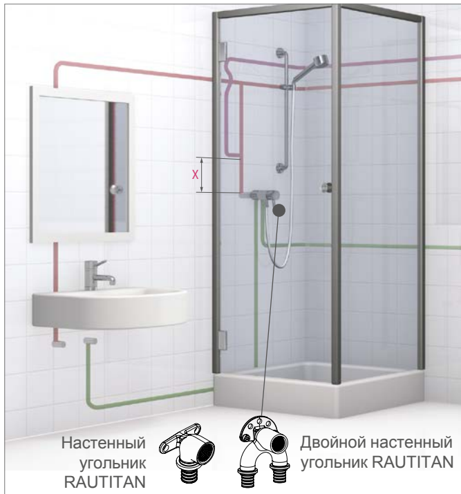
Рис. 5-5. Принцип работы кольцевого трубопровода с изогнутой Т- образной трубкой RAUTITAN RX+
