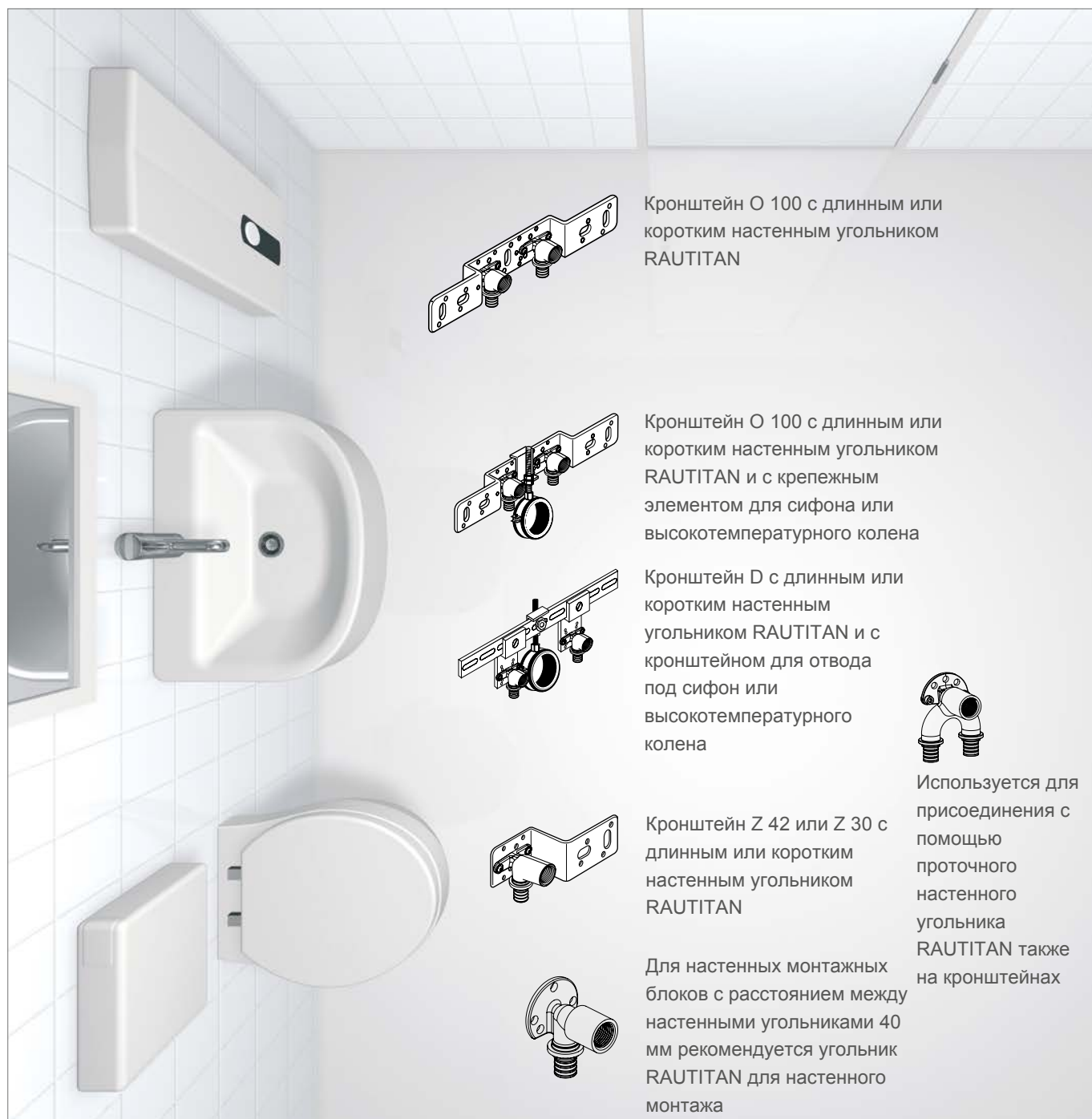
Рис. 6-8. Применение кронштейнов в гостевом санузле
