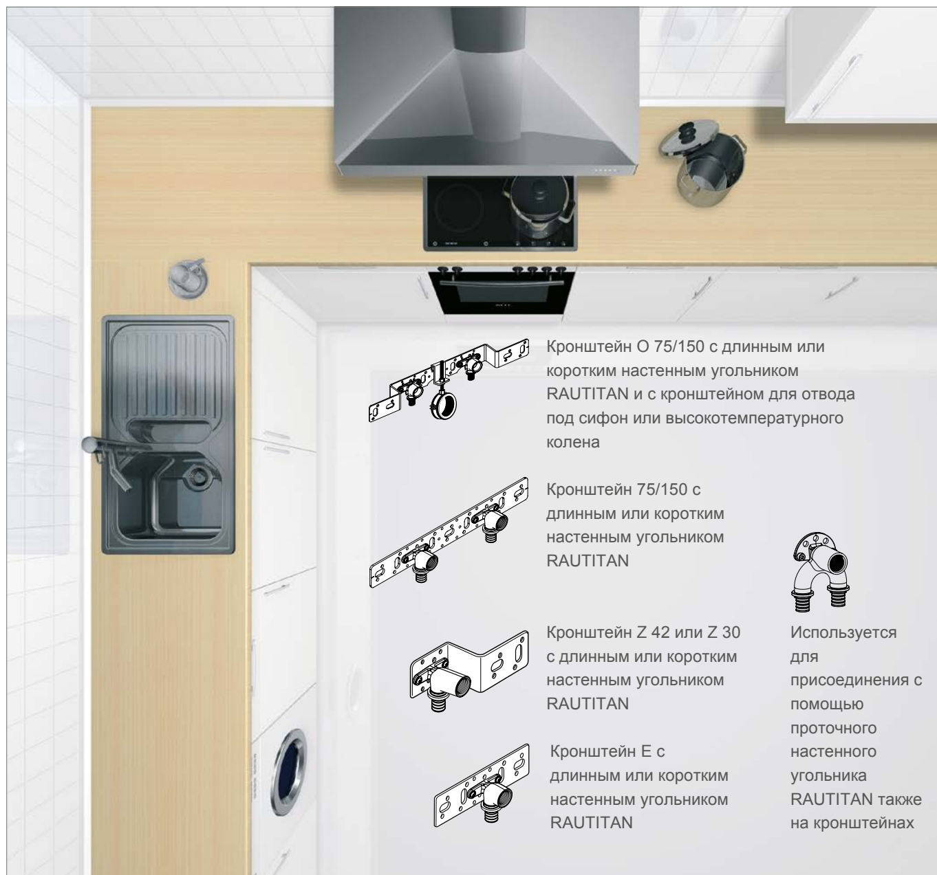
Рис. 6-7. Применение кронштейнов на кухне
